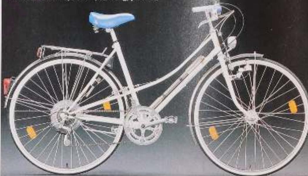
**Damenmodelle (TS):** gibt es mit Shimano-Positron-NEW 6-Gang-Schaltung mit Kettenschutz und alternativ mit Shimano-Positron-NEW 12-Gang-Schaltung mit Kettenschuttring in jeweils 3 verschiedenen Rahmenhöhen: 50, 53 und 57 cm. Weiters sind sämtliche Damenrahmen mit dem bewährten Trainingsbügel ausgestattet.
