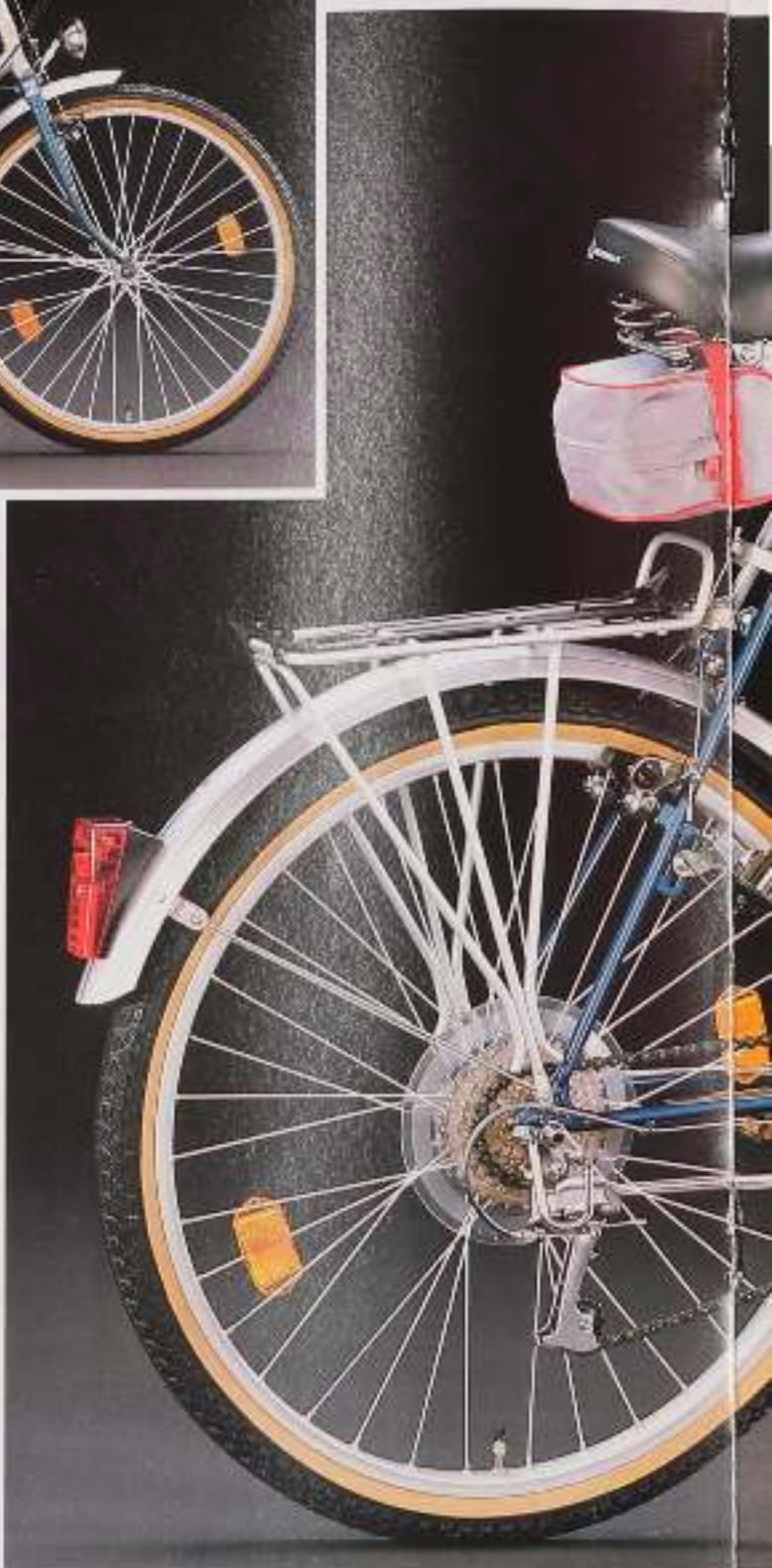
spann-Nabe vorne, Zahnkranzkassette 14-32 Zähne. ⑤ Bereifung 47-559 (26 x 1,75 x 2) mit Leichtlaufkamm, Shimano-M-450-EXAGE-Tretlager mit ⑥ Shimano-EXAGE Biopace-3fach-Kettenrad-Garnitur, Shimano-M-450-EXAGE-18-Gang, ⑦ Shimano-EXAGE-Schalt-/Bremshebelkombination am Lenker, Shimano-M-
